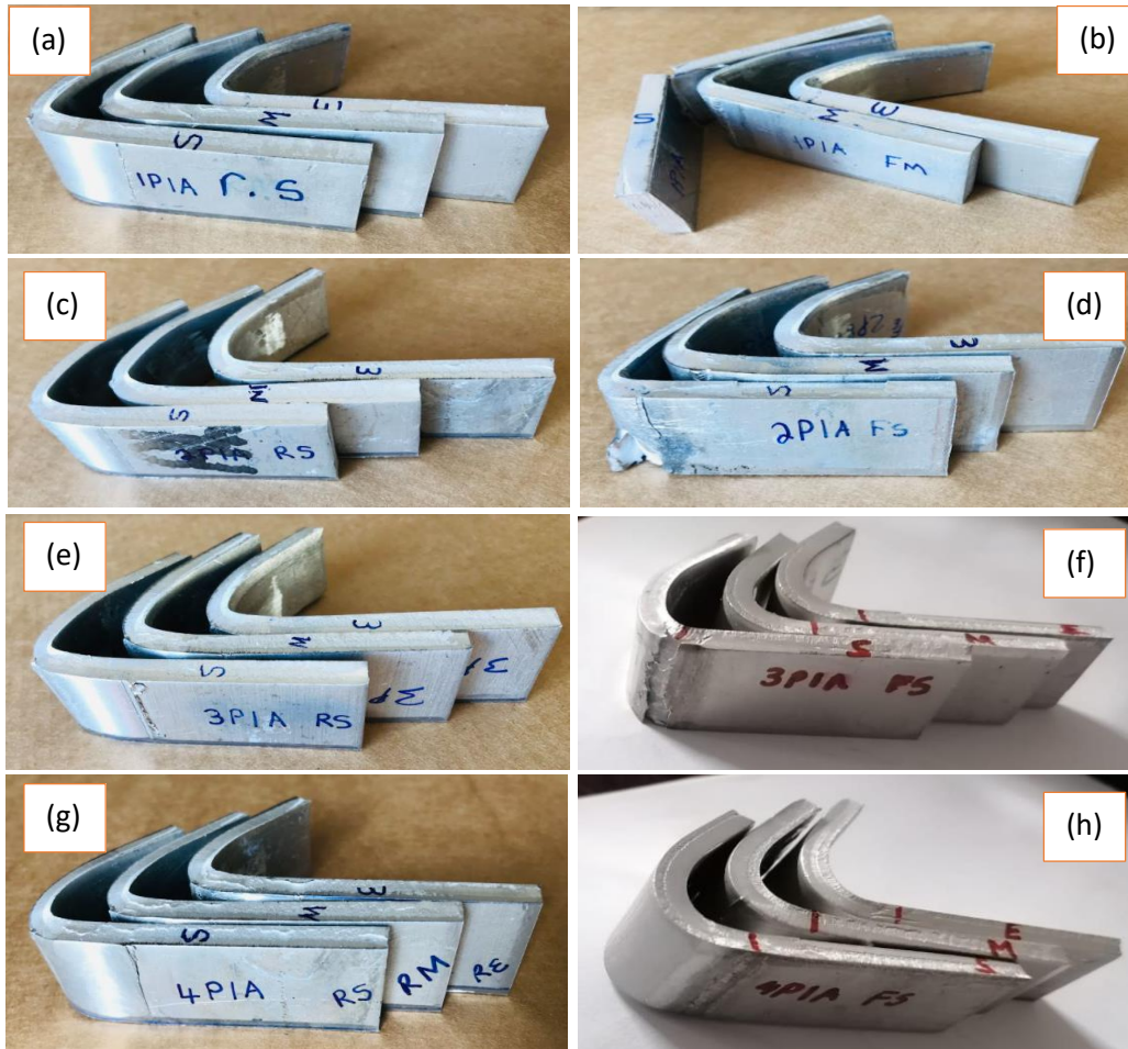
Figure 4.6.1: Post flexural test specimens; (a) 1P1050/6082 (Root), (b) 1P1050/6082 (Face), (c) 2P1050/6082 (Root), (d) 2P1050/6082 (Face), (e) 3P1050/6082 (Root), (f) 3P1050/6082 (Face), (g) 4P1050/6082 (Root) and (h) 4P1050/6082 (Face).
