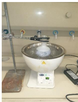
Figure 31: Detergent wash actual setup
