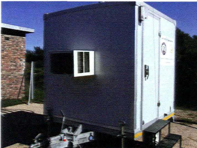
Figuur 3.1: Foto van die DO & OP Lugbesoedelingsmoniteringstasie wat gebruik is vir die meting van die konsentrasies van PM^{10} , O_3 , SO_2 en NO_2
