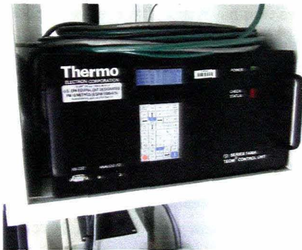
Figuur 3.6: Foto van die Thermo Partikulêre Materie (PM 10 ) analiseerder TEOM series 1400a.
